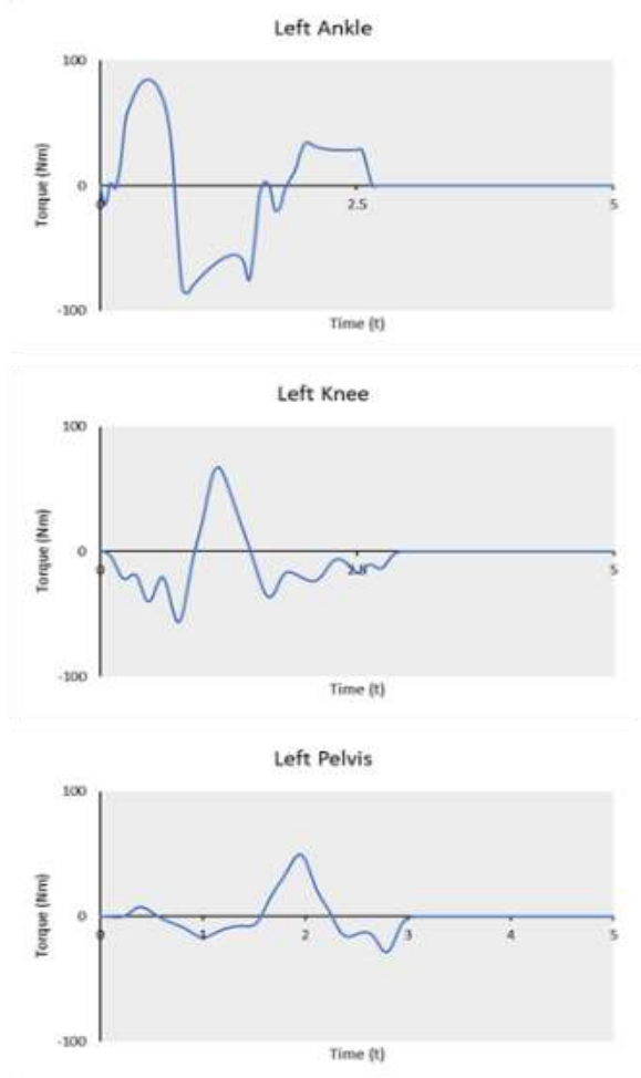
Gambar 3 Parameter-parameter Lagrangian dalam satu kali siklus gerakan berjalan.
