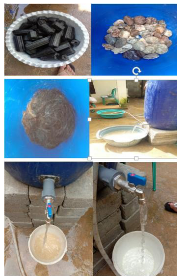
Gambar 4. Penyusunan Bahan dalam Drum dan Proses Penyaringan air
