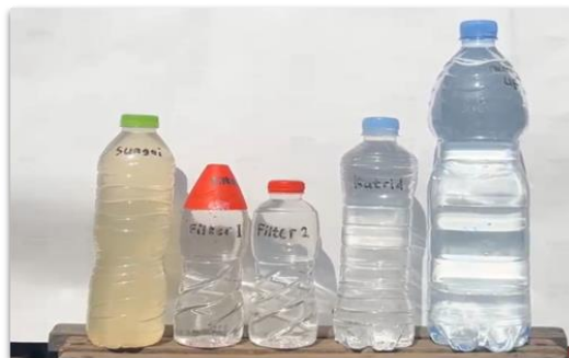
Gambar 4. Perbandingan air baku, hasil pengolahan tiap tahapan dan hasil akhir air bersih yang didapatkan
