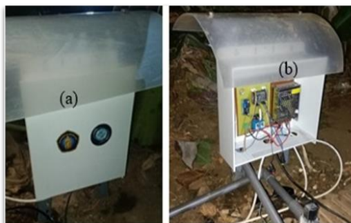
Gambar 4. Implementasi sistem IoT (a) Pengaturan drip irigasi berdasarkan kelembaban tanah (b) Pengaturan sirkulasi air berdasarkan tingkat TDS (Total Disolved Solid) dan ketinggian air kolam budidaya nila
