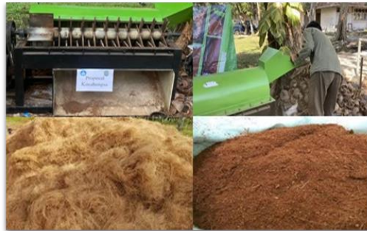
Gambar 2. Pengolahan serabut kelapa menjadi coco fiber dan coco peat
